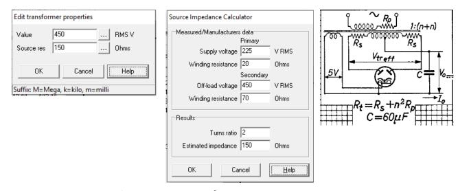
Figure 22. PSUD2 transformer parameter input screens.
